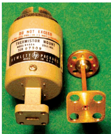
Obr. 7 : Příruba vlnovodu pro HP R486A
