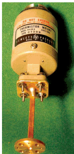
Obr. 8 : HP R486A termo-hlava s přišroubovaným vlnovodem WR12
