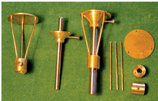
Obr. 9 Přípravky na výrobu přesných zářičů
