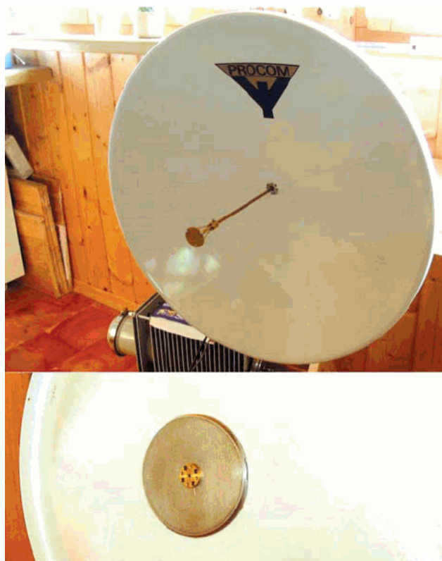
Obr. 10 Parabola Procom, dole se zpevňovací kalotou
