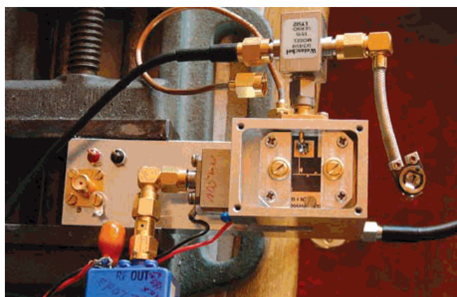
Obr. 3 Pokusné zapojení s potenciometrem pro přizpůsobení diody
