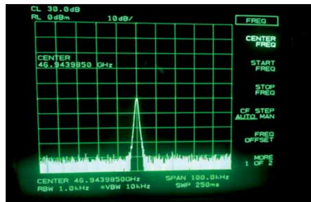
Bild 15: Spektrum des 46,944-GHz-LOs mit eingebautem OE9PMJ-Filter
