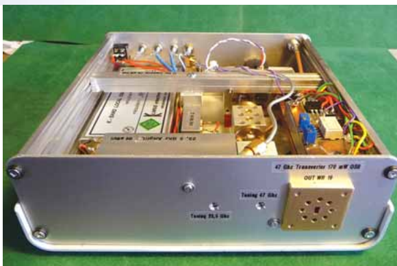
Bild 12 (links): 47-GHz-Transverter von oben, die Mikroschalter sind gut zu sehen
